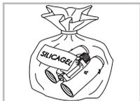
In caso il cannocchiale sia umido, è necessario asciugarlo prima di riporlo.
