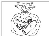
Lorsque les jumelles sont mouillées, il faut au préalable les sécher. Dans les zones tropicales ou dans des régions où règne une forte humidité ambiante, il vaut mieux entreposer vos jumelles dans un étui étanche à l'air doté d'un produit absorbant l'humidité (du type Silicage!).
