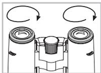
Faites tourner les deux bonnettes oculaires (dans le sens des aiguilles d'une montre) jusqu'à la butée.
