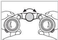
Genom att vrida fokuse-ringsringen kan du ställa in skärpan på föremål på mycket nära håll (se tekniska data) och upp till oändligt.
