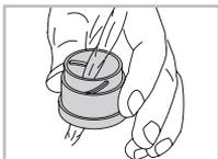
Bei starker Verschmutzung (z. B. Sand) sind die Drehaugenmuscheln komplett abschraubbar und somit einfachst zu reinigen.
