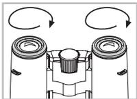
Drehen Sie beide Drehaugenmuskeln (im Uhrzeigersinn) bis zum Anschlag hinein.
