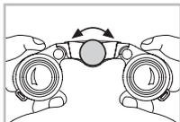
Ved at dreje på fokuserings-hjulet kan du stille skarpt på et ethvert objekt fra den korteste indstillingsafstand (se det tekniske datablad) til uendeligt.
