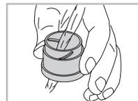
Bij sterke verontreiniging (bijv. zand) kan de oogklep er compleet afgeschroefd en het oculair daardoor eenvoudig gereinigd worden.
