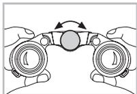
En faisant tourner la molette de focalisation, vous pouvez faire la mise au point sur chaque objet, de la distance minimum de mise au point (voir la fiche signalétique technique) à l'infini.
