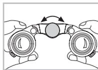
Ruotando la rotella de foca-lizzazione Le sarà possibile ottenere un'immagine nitida di qualsiasi oggetto posto ad una distanza ridotta (vedi scheda tecnica) fino all'infinito.
