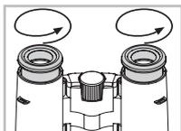
Draai beide draaidoppen (tegen de wijzers van de klok in) tot de aanslag eruit.
