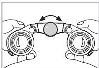
Durch Drehen des Fokussierendes können Sie jedes Objekt von der kürzesten Einstellentfernung (siehe Technisches Datenblatt) bis unendlich scharf stellen.
