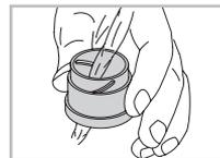
In caso di particolare sporco (p. es. sabbia), le conchiglie oculari girevoli possono essere svitate completamente e pulite con estrema facilità.
