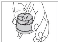
Finns det smuts som är svår att få bort från ögonmusslorna (t.ex. sand), kan man skruva ut dem och putsa dem skilt.
